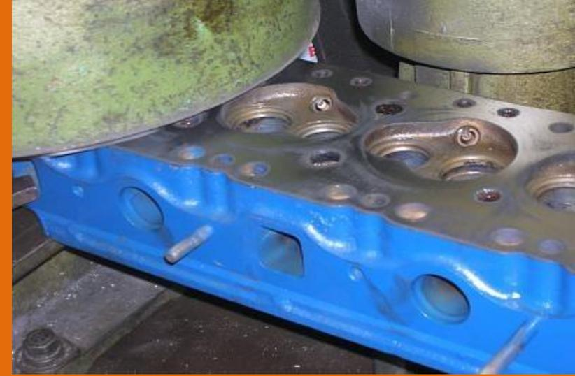
Se debe rectificar con cuchillas o muelas, en función del tipo de culata, no admitiéndose desviaciones de planitud superiores a 0,05 mm. El proceso de planificación se debe realizar entre 0,20 mm - 0,25 mm normalmente, en función de los daños de la culata o de su alabeo, la distancia a planificar puede variar, hasta garantizar la efectividad del planificado.
