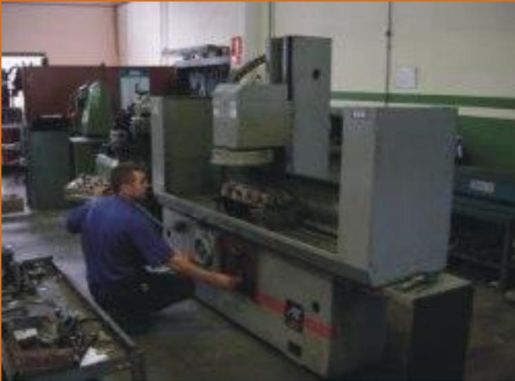
En esta maquina se puede rectificar cualquier superficie plana con anclaje o con una mesa magnética, normalmente se cepilla la culata cuando esta se a sobrecalentado y deformado la superficie que sella con el monoblock .
