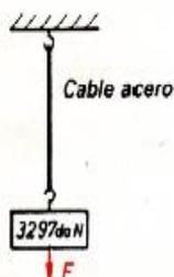
11.6 Un cable de acero consta de 30 alambres de  $\varnothing 2$  mm cada uno. Su resistencia a la tracción es  $\sigma_a = 1\,500$  N/mm<sup>2</sup>. La sollicitación a tracción del cable es de 3 297 daN.
