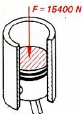
**17.8** a) La cabeza de un pistón de motor Otto tiene un diámetro de 70 mm y por la combustión del gas se carga con 15 400 N. ¿Cuál es la presión en la cabeza del pistón, en bar?
