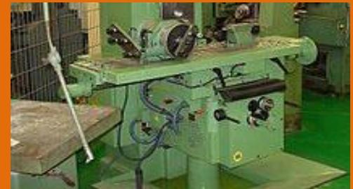
4: Carro Transversal: El carro transversal se apoya y puede deslizarse por las guías horizontales de la mésula por medio de las guías.
