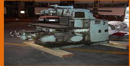
2: El Cuerpo o Columna: El cuerpo o bastidor tiene forma de columna y se apoya sobre la base o ambas forman parte de la misma pieza. Habitualmente, la base y la columna son de fundición aleada y estabilizada.
