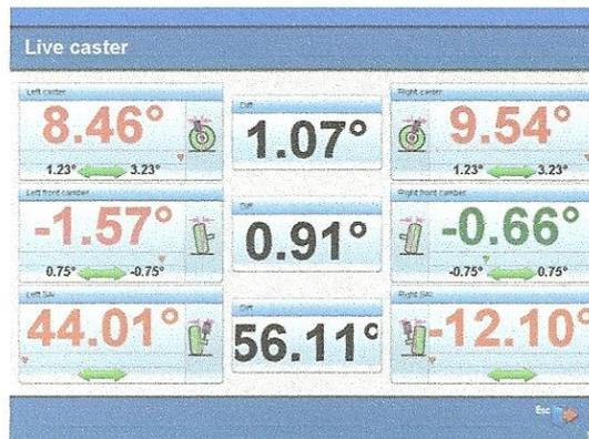
**Pantalla de ajuste y medición dinámica Kingpin**
