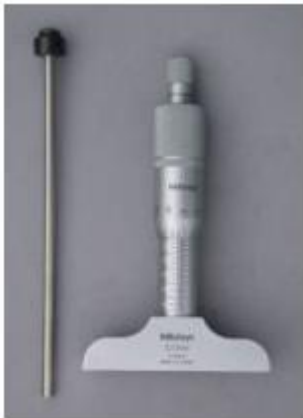
Caja de micrómetros de profundidad (1 micrómetro con adaptaciones).
