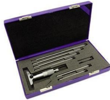
Caja de micrómetros de profundidad (1 micrómetro con adaptaciones).
